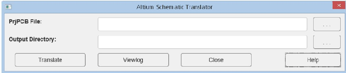
Le schéma Altium doit être embarqué dans projet PCB (.prjPCB) qui gère les données du projet pour la fabrication.
