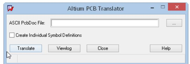
Pour le schéma, il faut que le projet Altium ait été sauve au format Advanced Schematic ascii (\*.SchDoc).
